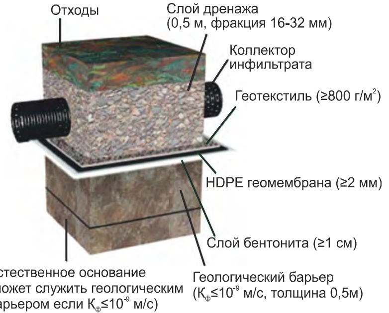
Формирование основания ячейки захоронения отходов
